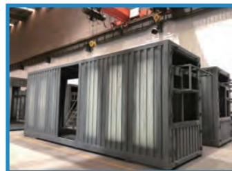
Prefabricated DfMA units 「可供製造及裝配的設計」的預製組件
